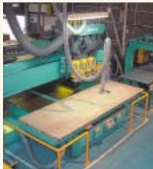
外壁面材切断用四軸NCルーター
