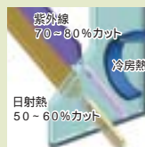
遮熱・高断熱複層ガラス 省エネルギー (熱損失防止)
